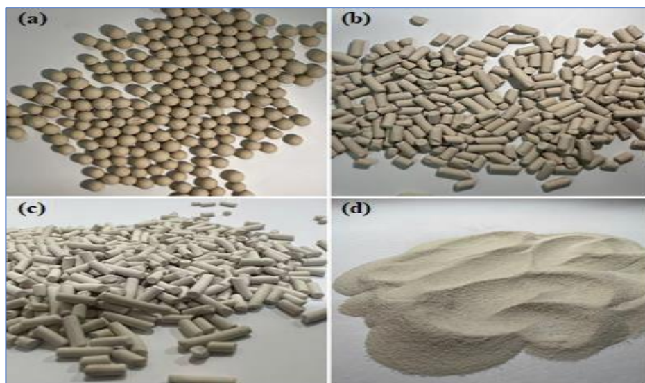
Figure IV- 6: Zéolithes synthétiques de type 3A (a), 4A (b), 5A (c) et Y (d).
