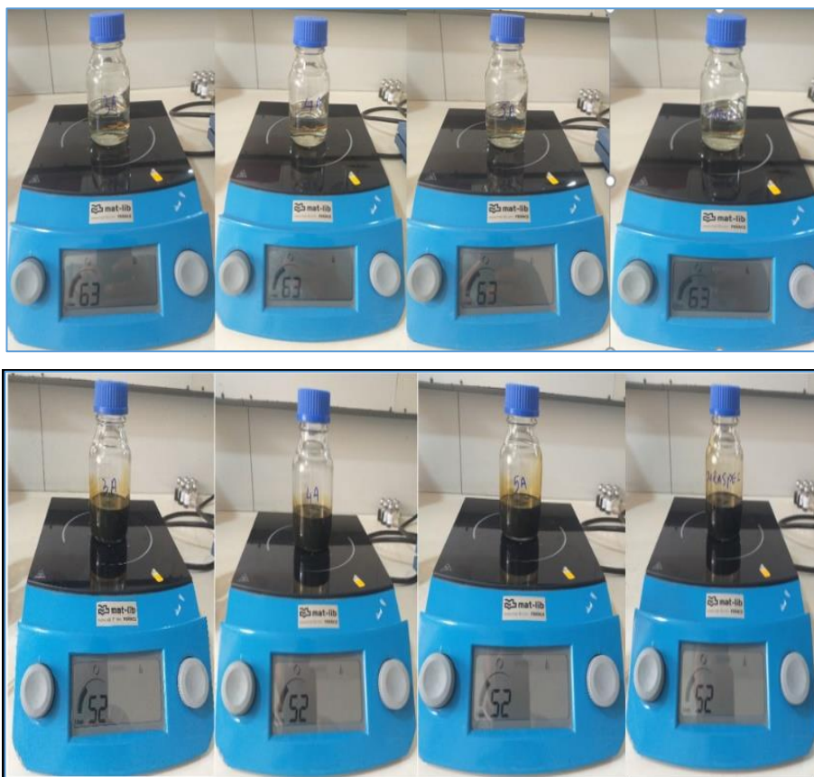
Figure V-13 : Agitation des liquides de condensat et de pétrole en présence des adsorbants.
