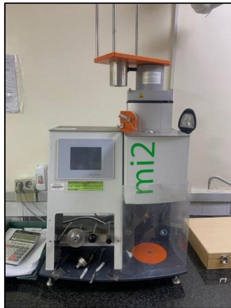
Figure III - 3 Appareillage utilisé pour mesurer l'indice de fluidité
