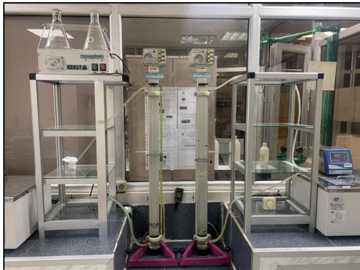
Figure III - 6 Appareillage utilisé pour mesurer la densité.
