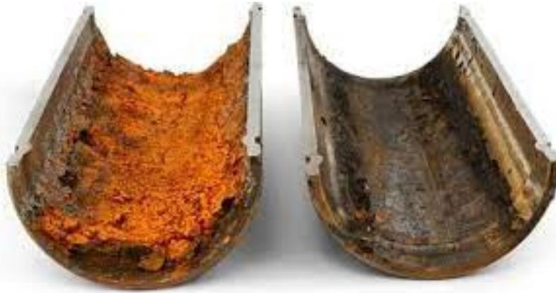
FIGURE 2.3 – Corrosion Généralisée
