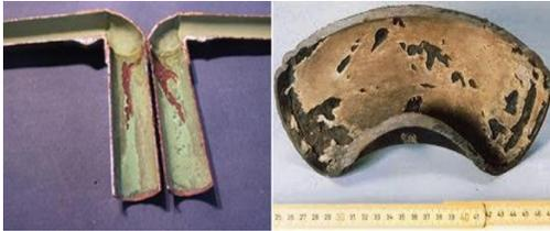
FIGURE 2.4 – Exemple 1 de l'erosion-corrosion cavitation
