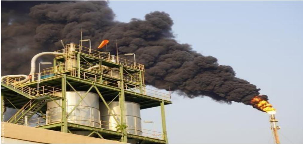
**Figure IV.5:** Combustion incomplète
