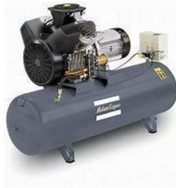
Figure III.3: compresseur à piston
