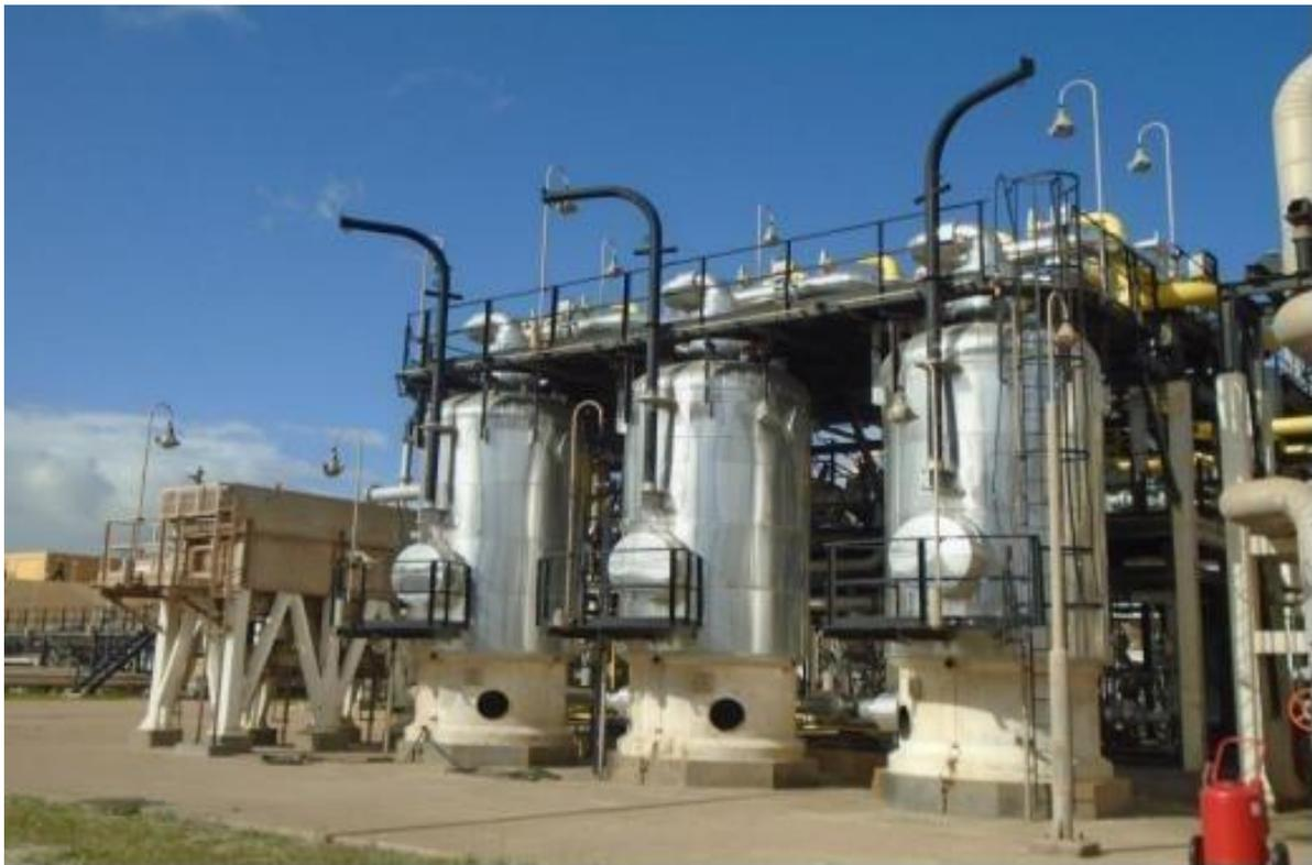
Figure II.7:section de déshydratation.
