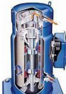
Figure III.4 : Le compresseur à spirale
