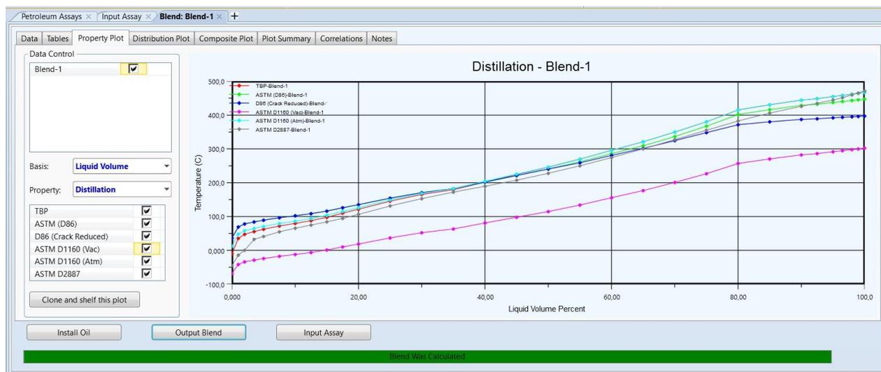
**Figure IV.14 : Courbes de distillation de nouvelle charge**
