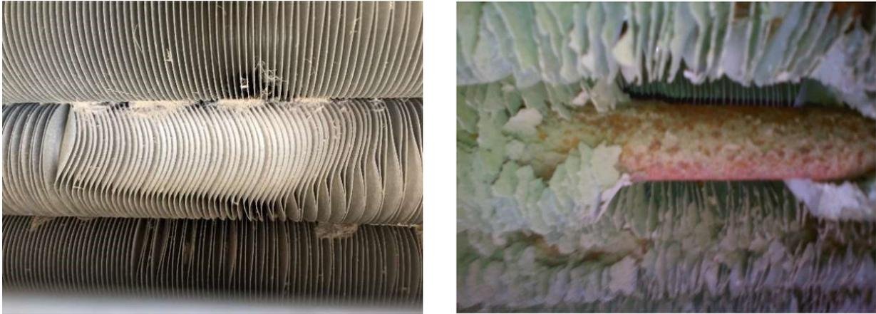
*Figure III-11: Encrassement et déformation des ailettes*
