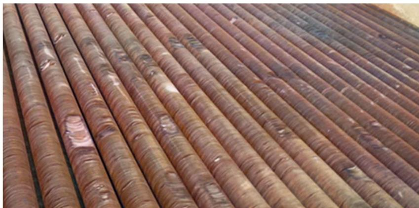
*Figure III-12: Phénomène de corrosion des ailettes*
