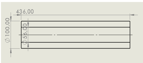
Figure II.1 : Dessin de brute de la trompette en 2D
