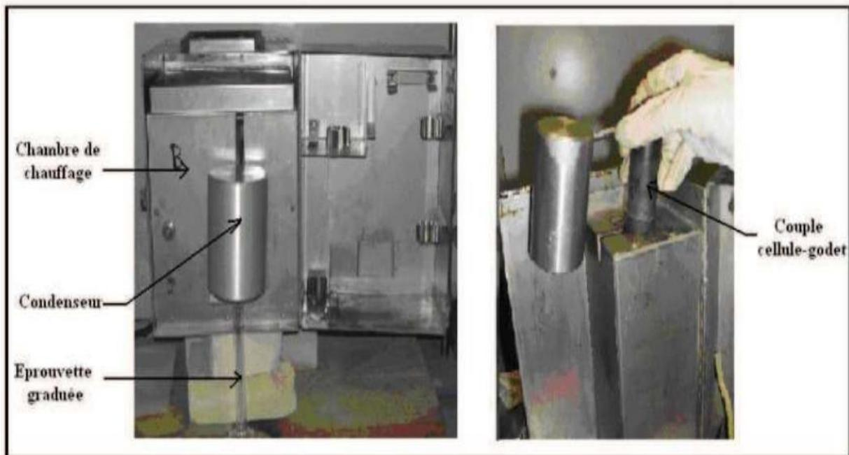
**Figure 22** : Photo Montage de la cellule avec le godet.
