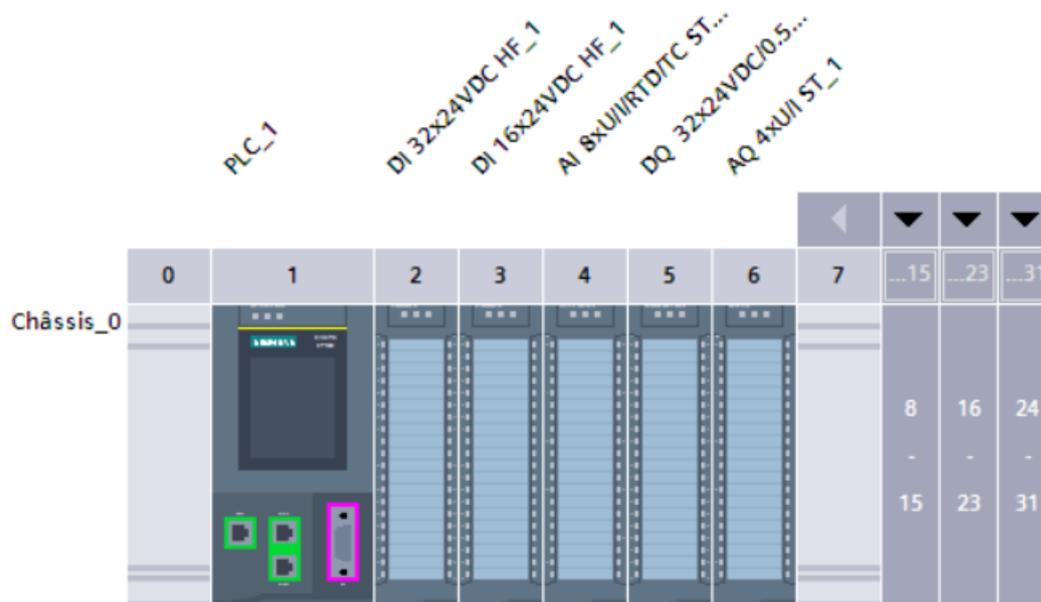
Figure V.4 La configuration des appareils
