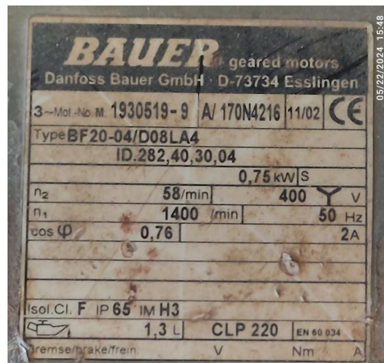
Figure II.21: La plaque signalétique d'un moteur des moteurs d'une section du système de convoyage
