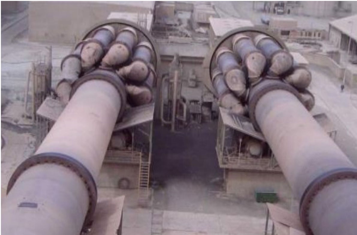
Figure I.6. Cuisson « formation du clinker »
