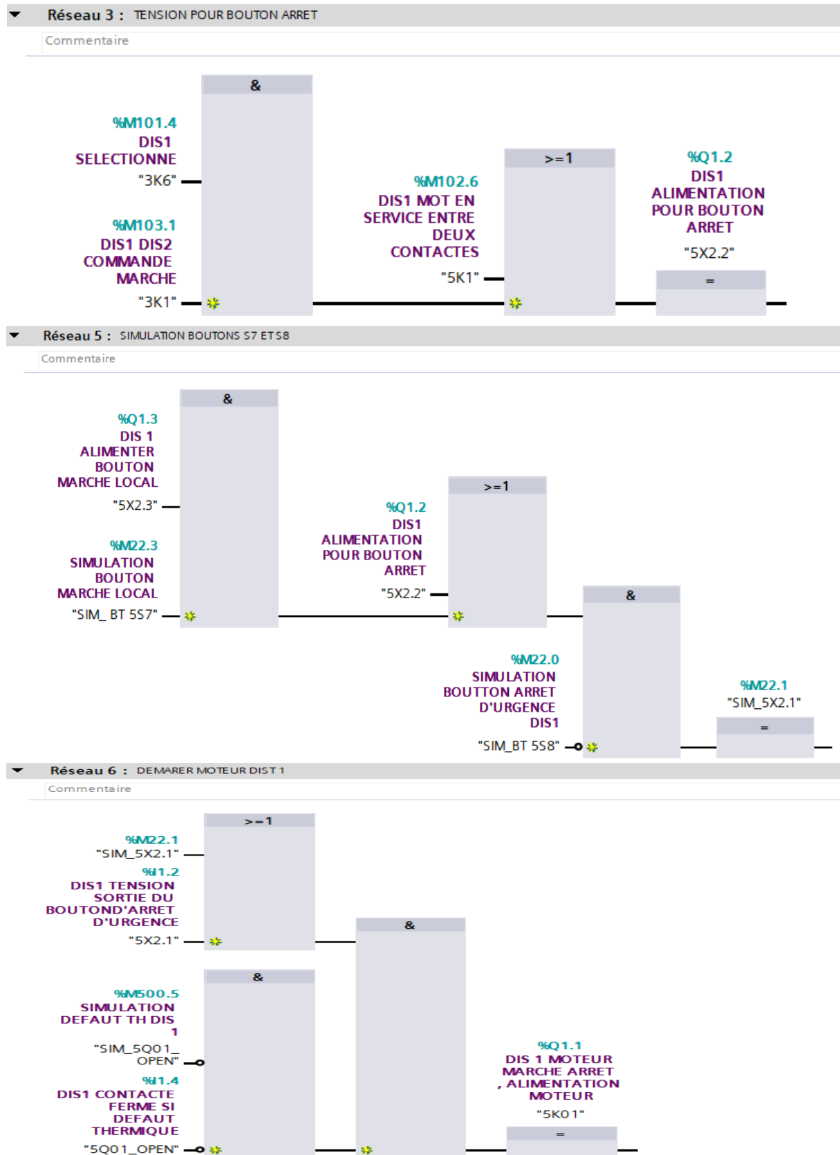
Figure III.19. Réseaux pour marche moteur de distributeur 1
