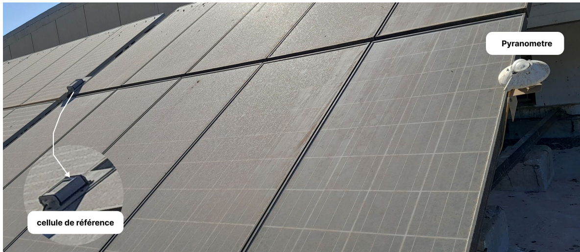
Figure IV. 16 La vue réelle de la cellule de référence et pyranomètre
