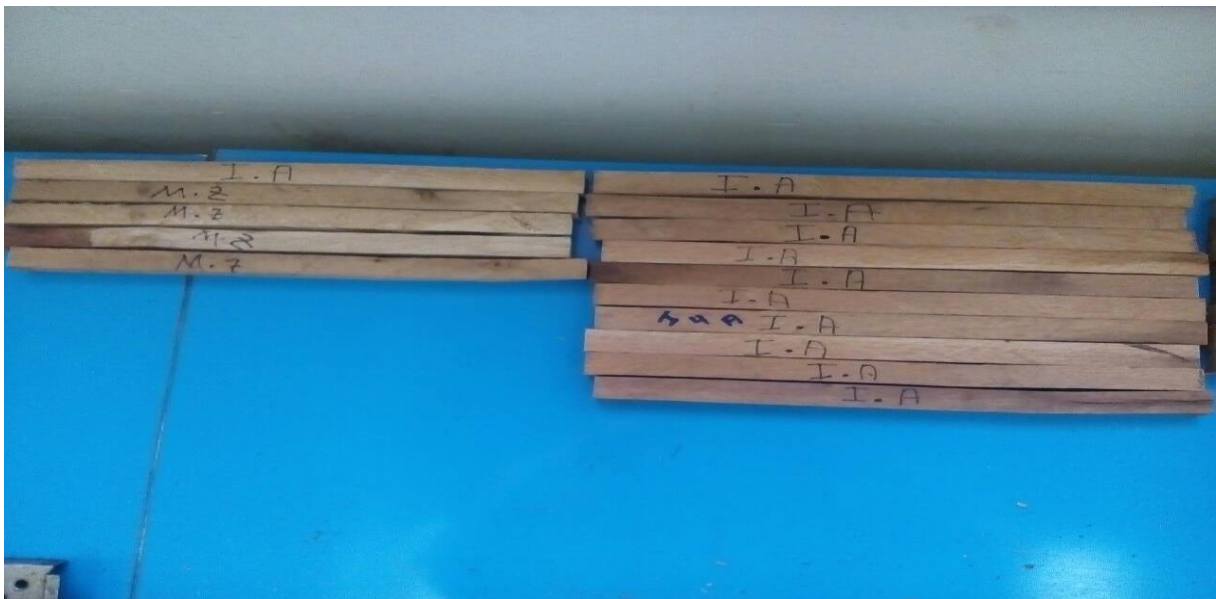
Figure 3.14 : Echantillons de flexion 4 points
