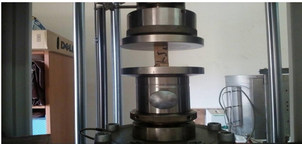
Figure 3.13 : Essai de compression selon la norme NF B51 007
