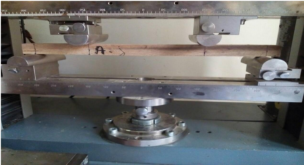
Figure 3.15 : Essai de flexion 4 points
