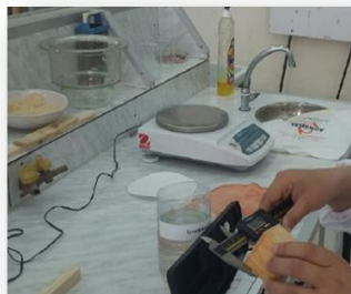
Figure 3.9 Mesure des dimensions des cubes
