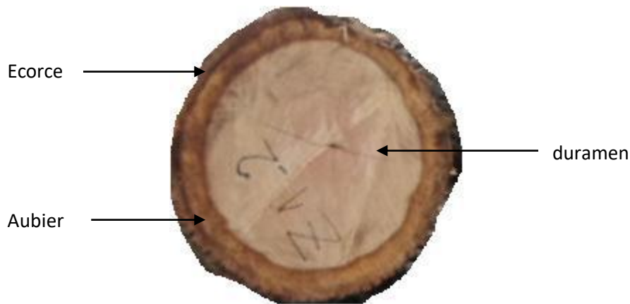
Figure 2.5 : Illustration des différentes parties d'un tronc de chêne Zeen
