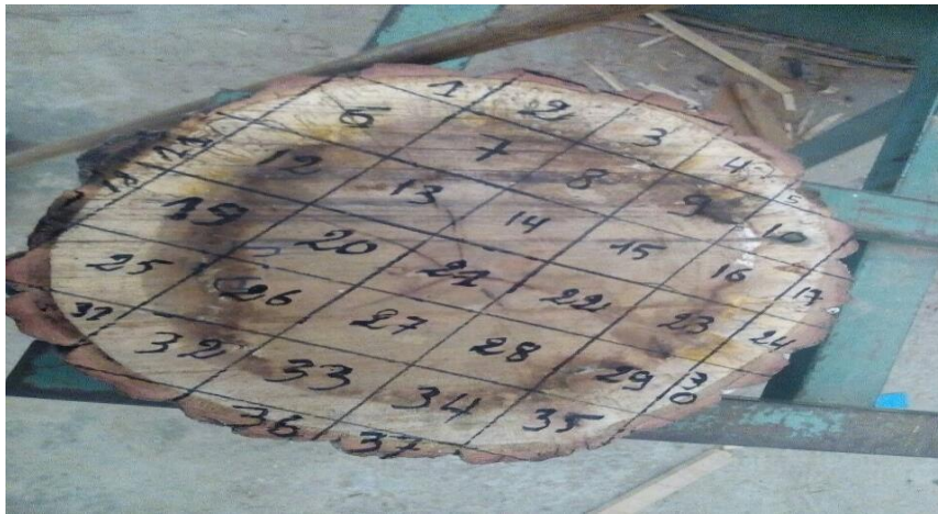
Figure 3.5 : Rondelle pour la caractérisation de l'humidité
