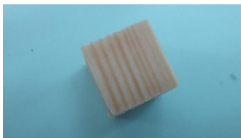
Figure 3.10 : Eprouvettes d'essai pour déterminer la masse volumique
