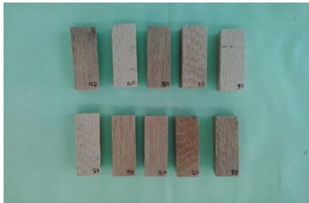
Figure 3.12 : Eprouvettes de l'essai de compression
