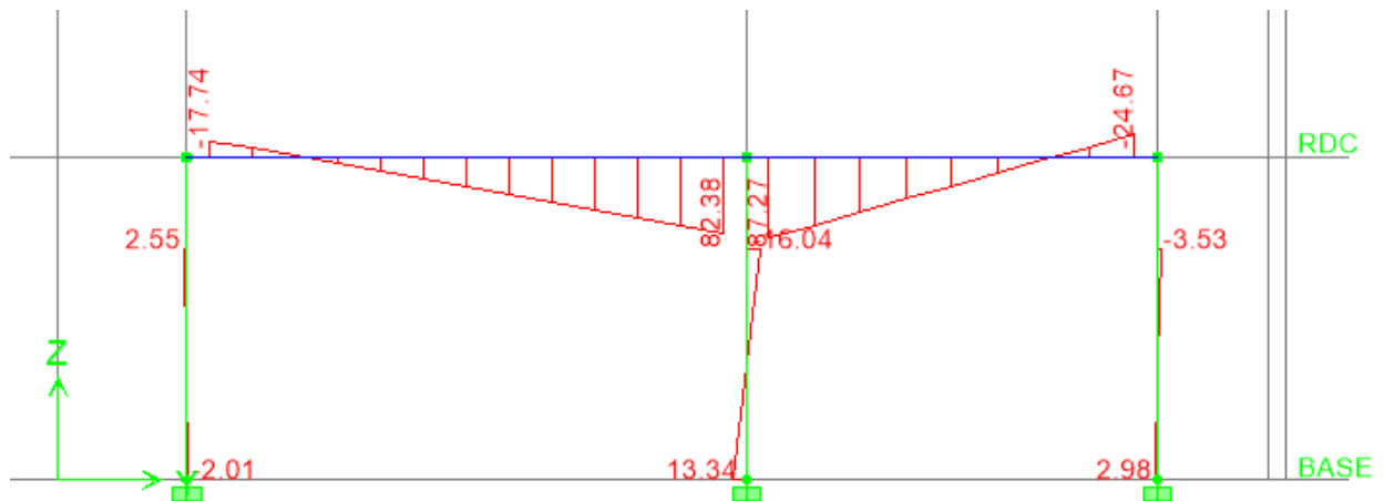
Figure VI.11 : Diagramme du moment fléchissant a l'ELU (sens y-y)
