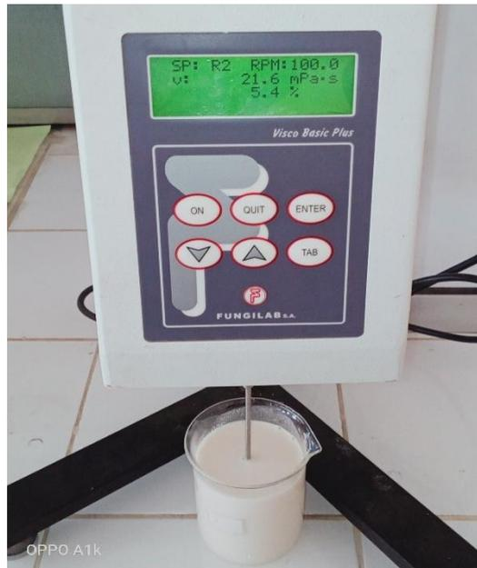
**Figure 12 :** Détermination de la viscosité par Le viscosimètre
