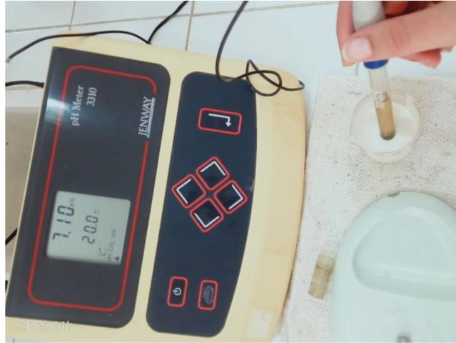
**Figure 11 :** Détermination du potentiel hydrogène des formulations
