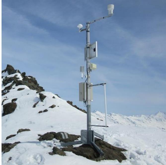
*Figure 1.2: Disdromètre de pluie*
