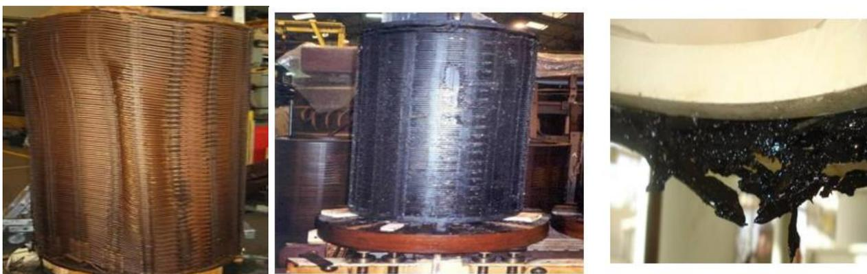
**Figure III.7: Effort électrodynamique franc, Joint de traversée écrasé et échauffement excessif d'un enroulement**
