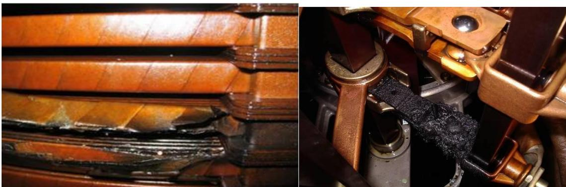
Figure III.6 : Amorce entre spires et point chaud du sélecteur du régulateur en charge
