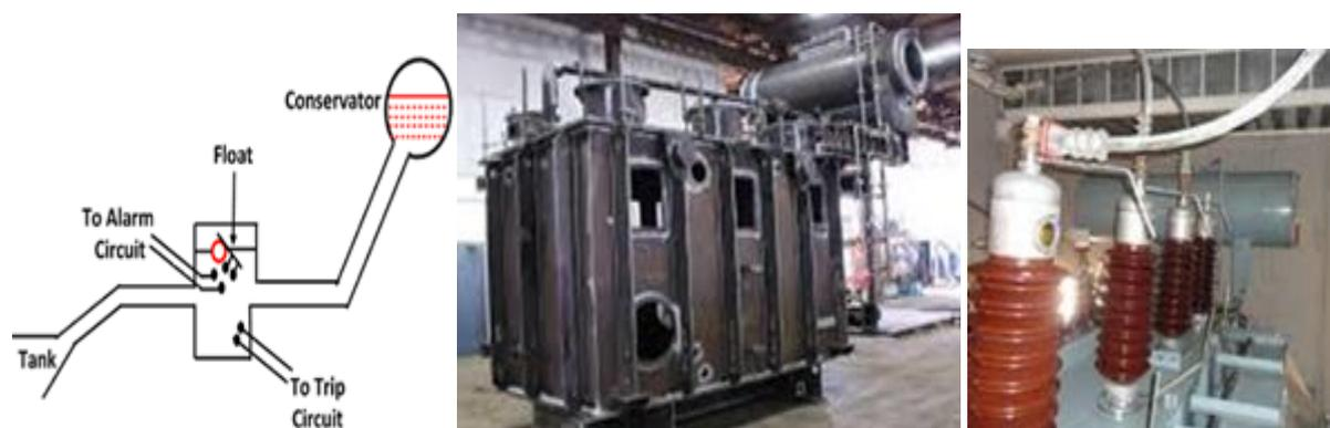
**Figure II.16 : Connexion de relais de Buchholz, cuve et Traversées d'un transformateur de puissance.**
