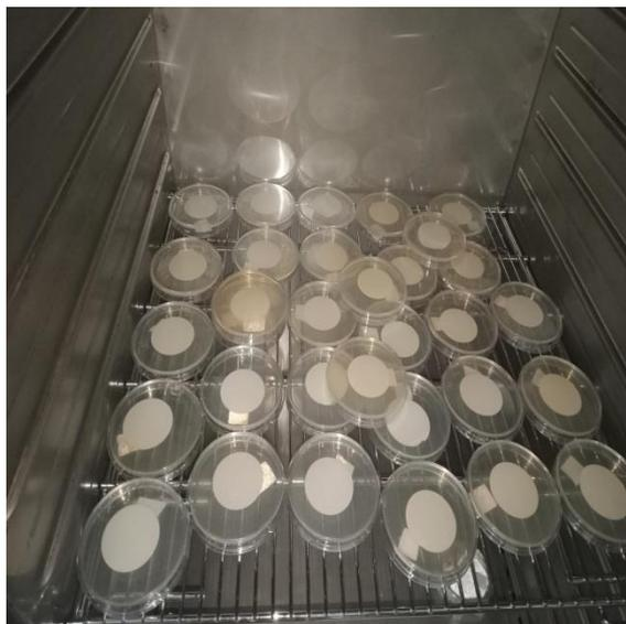
Figure 26 : Incubation des boîtes de pétri contenant les membranes filtrantes
