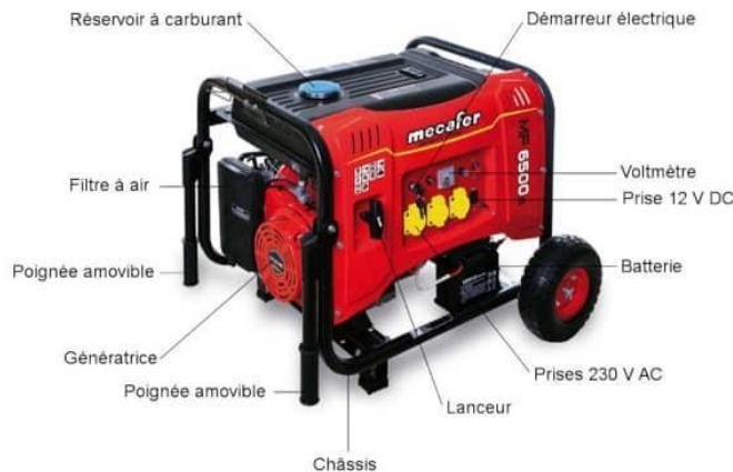
Figure 8: Description des composants du groupe électrogène
