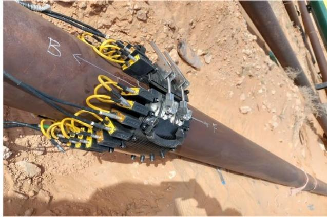
*Figure II.10. Photographie des palpeurs de LRUT installés sur tube*
