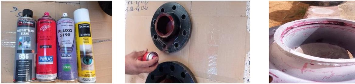
*Figure II.3.Principe du ressuage*
