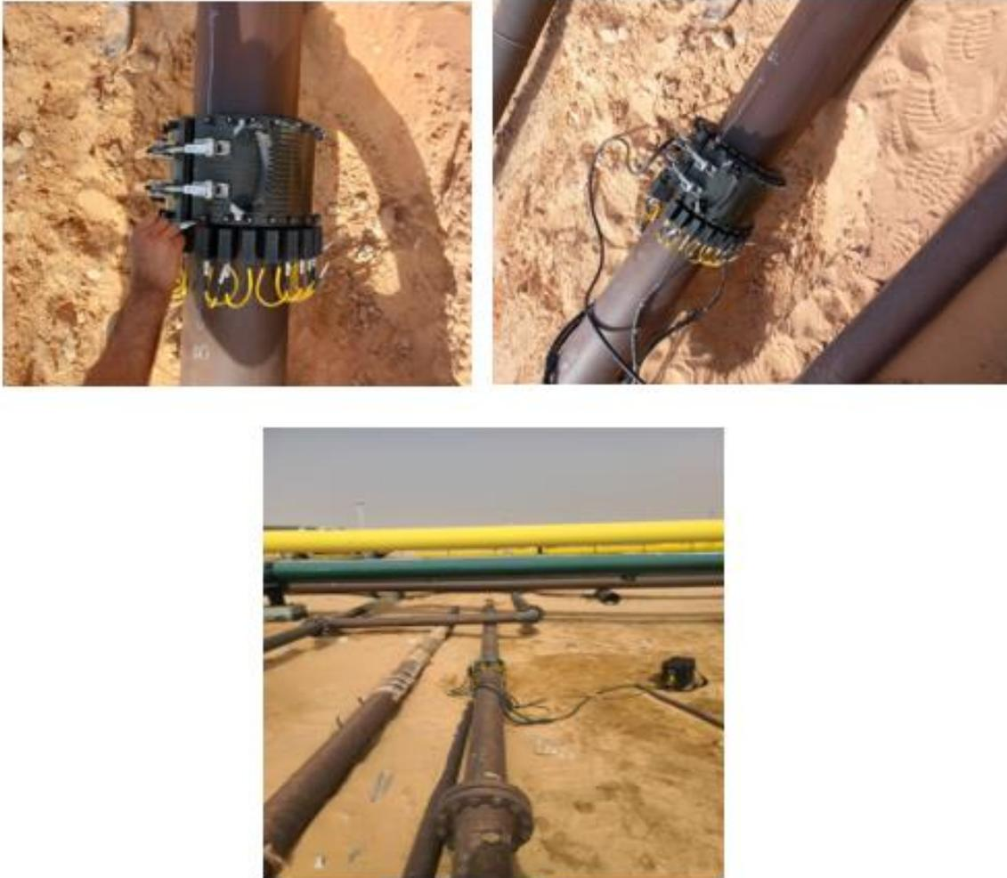
*Figure IV.8. Photographie de la ligne 8'' sous contrôle LRUT*
