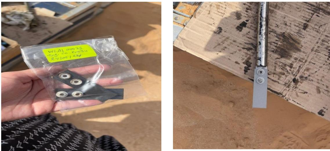
Coupon de corrosion (plaquettes calibrées)
