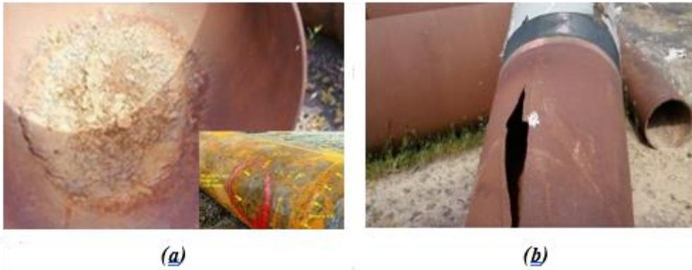
**Figure V.1.**Photo pipeline avec phénomène de corrosion interne. (a) : Corrosion biologique (interne) ; (b) : éclatement pipeline
