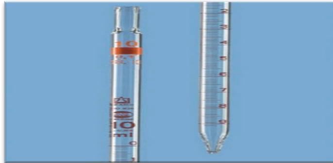
**Figure V.16 :** La pipette graduée.
