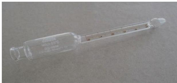
Figure V.6 : Le butyromètre Gerber.
