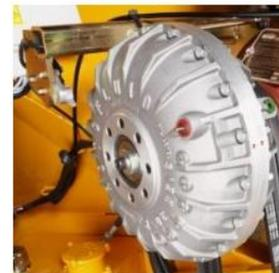
**Figure III.11 Coupleur hydraulique**
