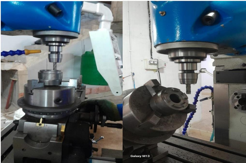
**Figure VI.15. Fabrication des dents**
