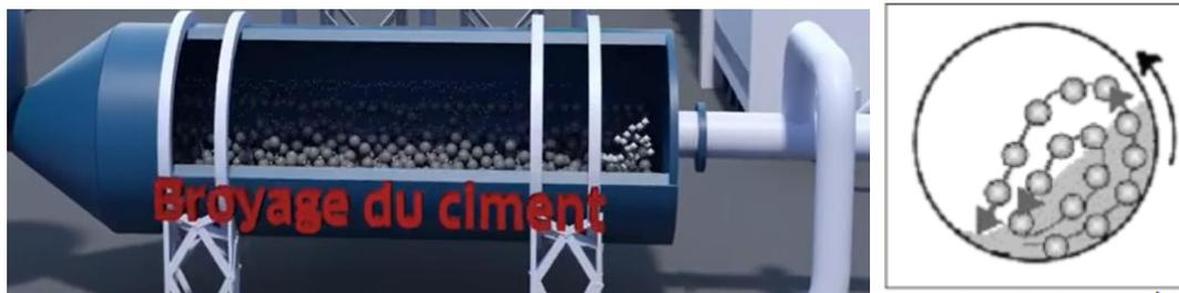
Figure II.3 Broyeurs à boulets
