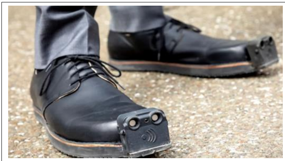
Figure I. 06 : chaussure alimentée par des capteurs à ultrasons
