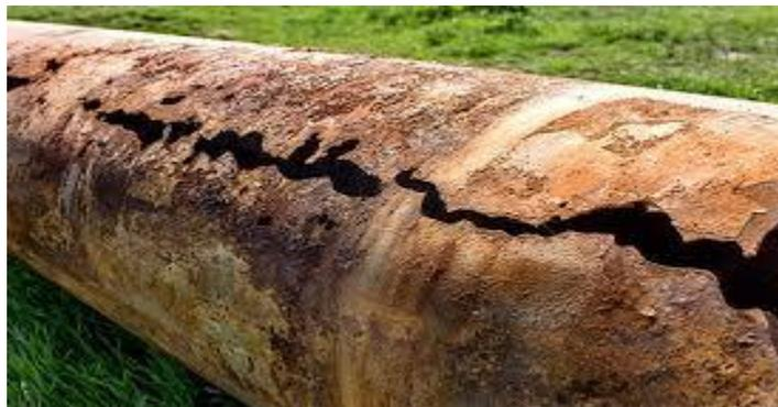
**Figure I-6:** Corrosion érosion
