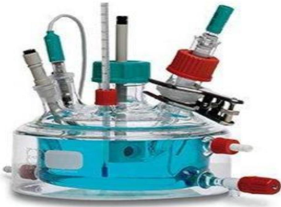
**Figure IV-2:** Cellule électrochimique.
