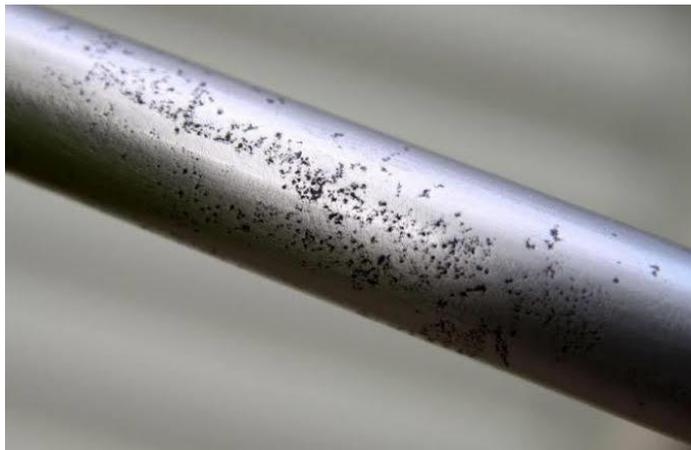
**Figure I-8:** Corrosion par piqûres
