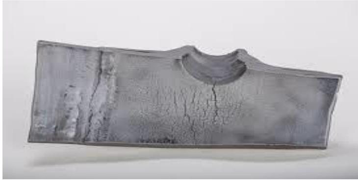
**Figure I-13:** Corrosion sous contrainte
