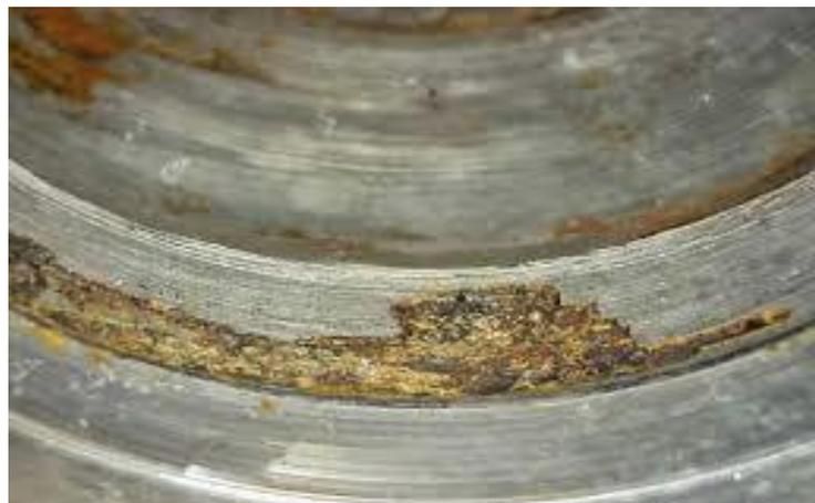
**Figure I-10:** Corrosion sélective.
