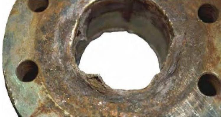
**Figure I-7:** Corrosion par crevasses.
