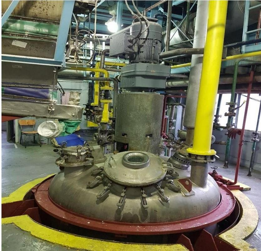
**Figure I.17 : Réacteur Résines.**
