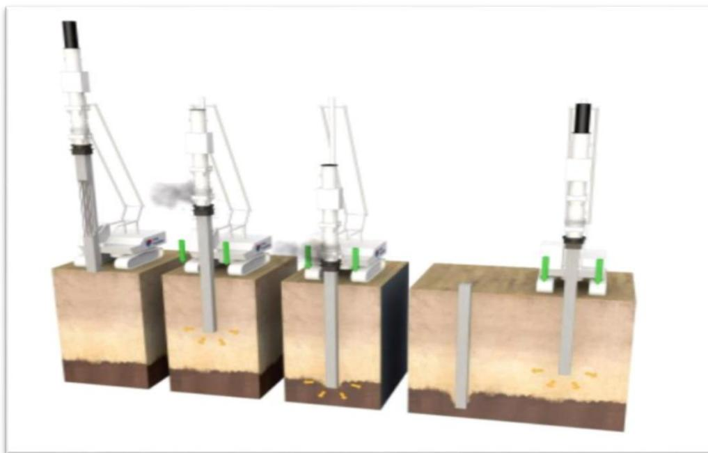
Figure I-12 Pieux battu en béton préfabriqué
