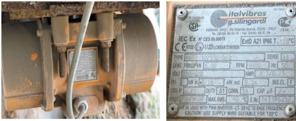
Figure I-10 : Moteur de trémie vibrante.
