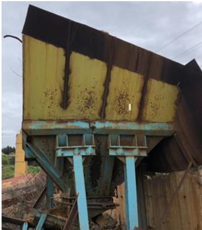
Figure I-1 : Trémie vibrante.
