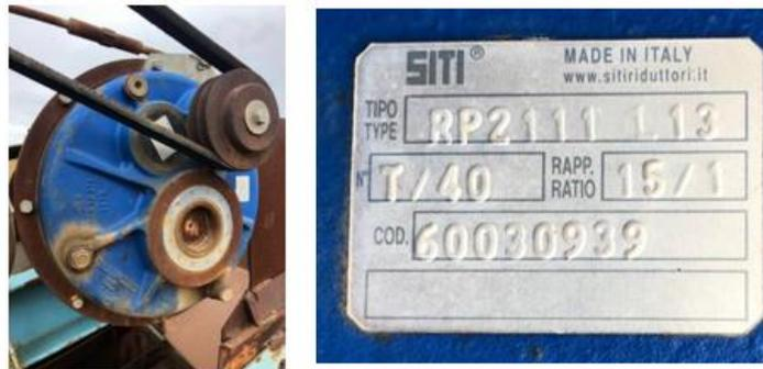
Figure I-5 : Réducteur moteur de tamis et ça plaque signalétique.
