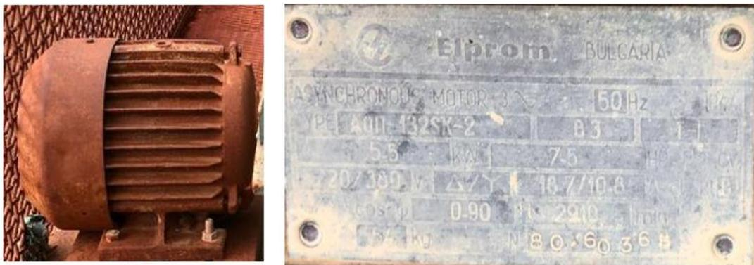
Figure I-11 : moteur de tamis vibrant.
