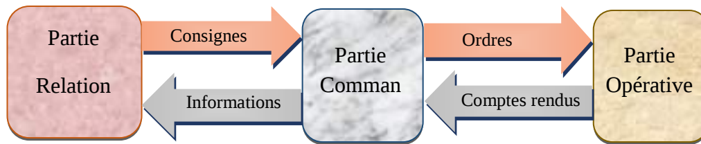
Figure [III.13] : Les parties d'un système automatisé. [22]
