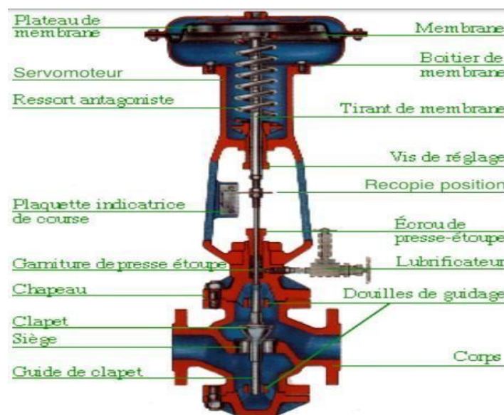
Figure [II.15] : Schéma d'une vanne régulatrice. [3]
