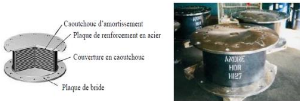
Figure 1.21.a : photo et schéma d'un isolateur en élastomère d'amortissement élevé (HDRB)
