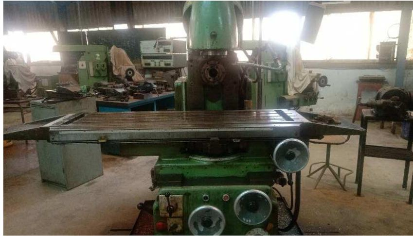
Figure.III.1 : La Fraiseuse (FE300)
