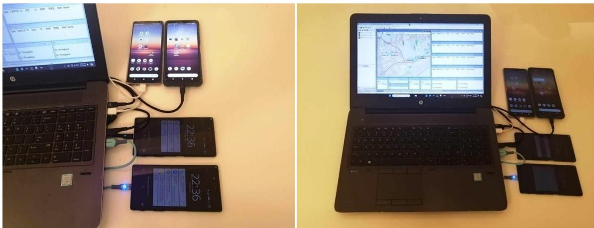
Figure 4. 1 : Equipement réel pour le Drive Test
