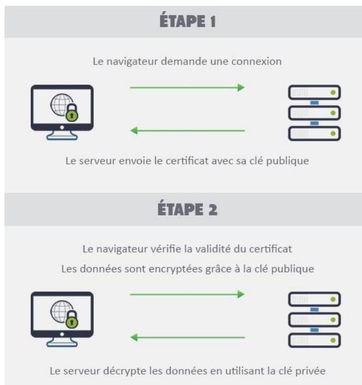
Figure II.6: Fonctionnement de Protocol de sécurité HTTPs [w18]
