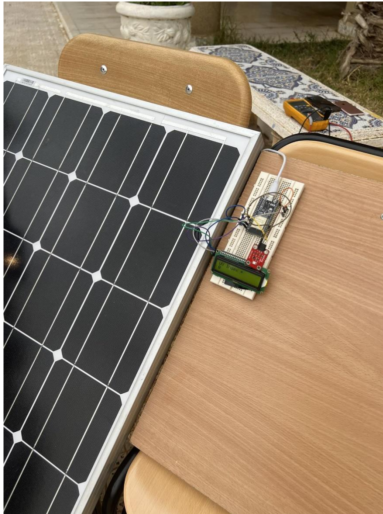
Figure III.14-Montage électronique GUVA-S12SD et LCD avec ESP32
