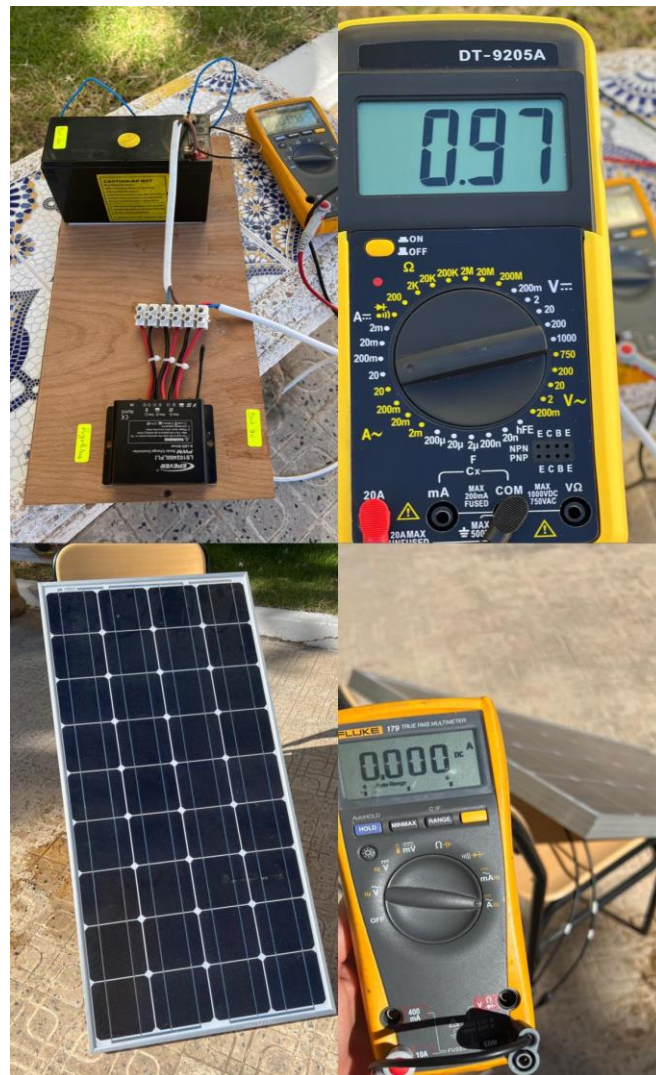
Figure III.18- Panneau PV et la chaîne photovoltaïque
