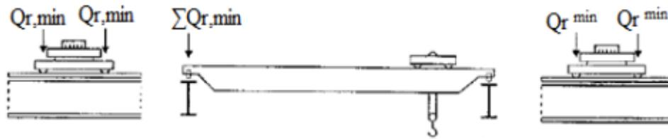
**Fig.VI-4 :** Dispositions des charges de l'appareil de levage à vide pour obtenir un chargement maximal sur la poutre de roulement
