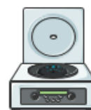
centrifugeuse avec rotors à godets pivotants (eppendorf, tubes)
