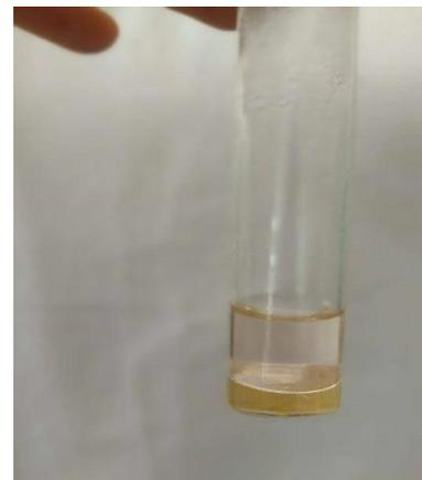
On récupère la phase supérieure et on mesure sa densité optique (D.O) à une longueur d'onde de  $\lambda = 520 \text{ nm}$  à l'aide d'un spectrophotomètre.
