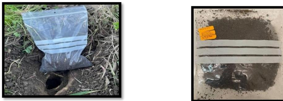
**Photo 4.** Prélèvement et conservation des échantillons de sol
