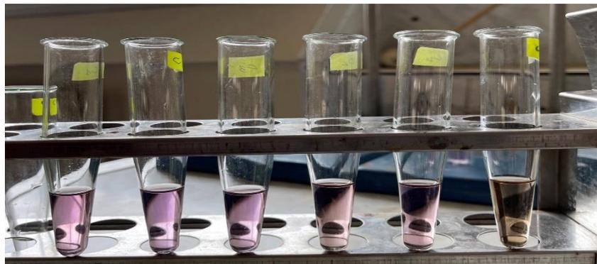
Photo . gamme d'étalonnage d'acide ascorbique
