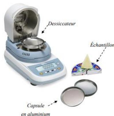
Figure III.5. Thermo-balance modèle...pour la mesure de l'extrait sec (%)
