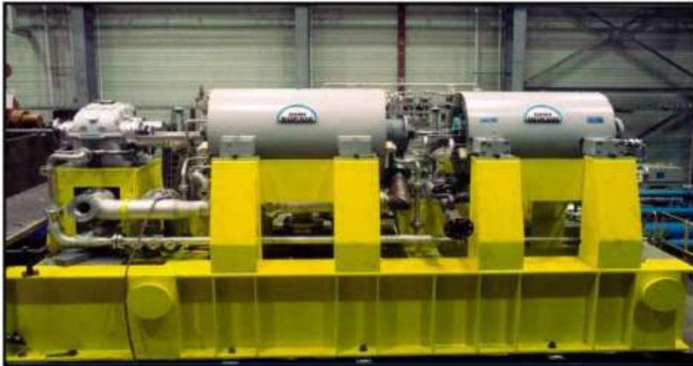
Figure I.5 : Compresseur centrifuge
