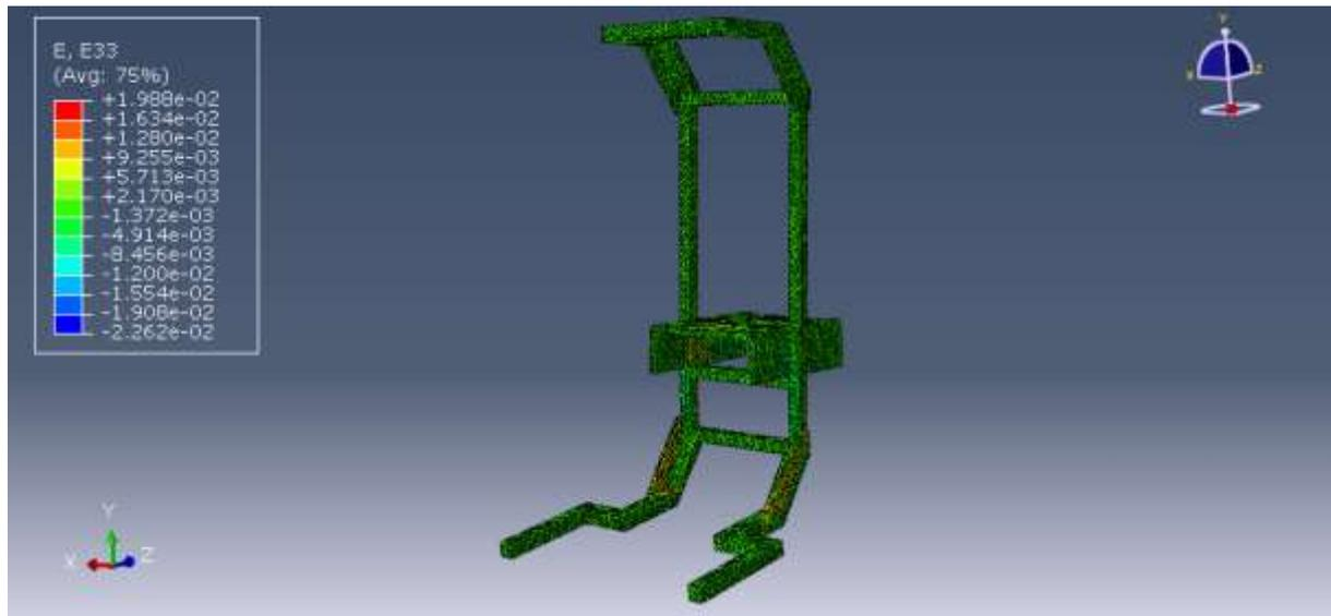
**FigureIV.24** : Déformations avec renforcement sur l'axe ZZ
