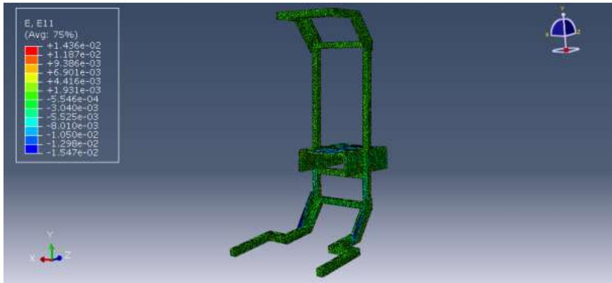
FigureIV.22 : Déformations avec renforcement sur l'axe XX
