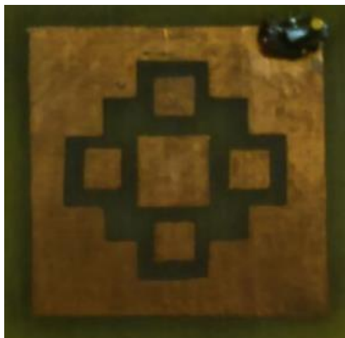
Figure 3.10. Prototype de l'antenne patch proposée utilisant la géométrie fractale [49]
