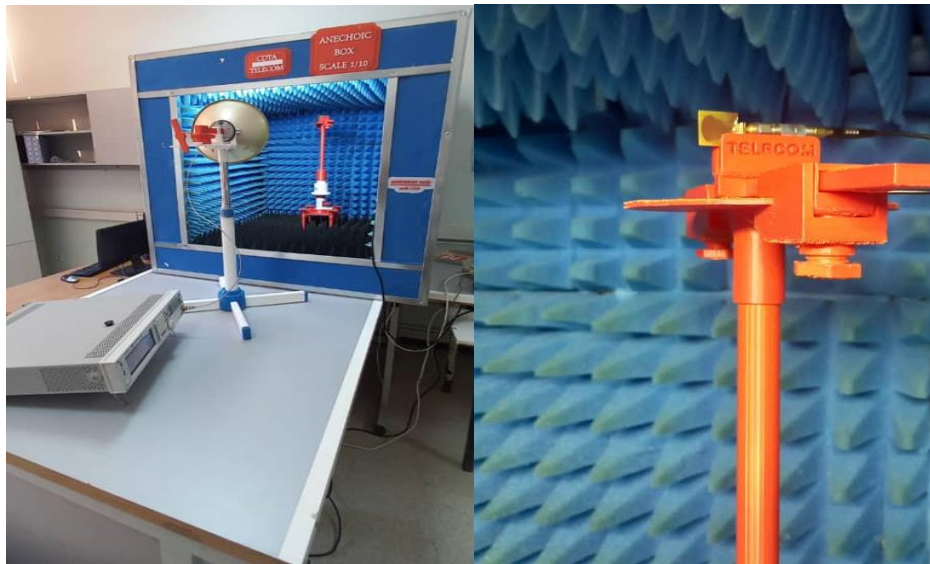
Figure 4.18. Montage de mesure du gain et du diagramme de rayonnement de l'antenne proposée
