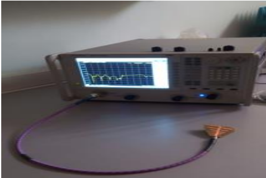
Figure 4.31. Mesure du S11 de l'antenne proposée
