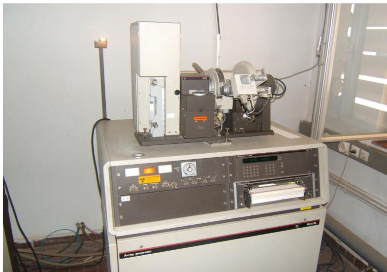
*Fig.II.5 : le diffractomètre de rayon X*
