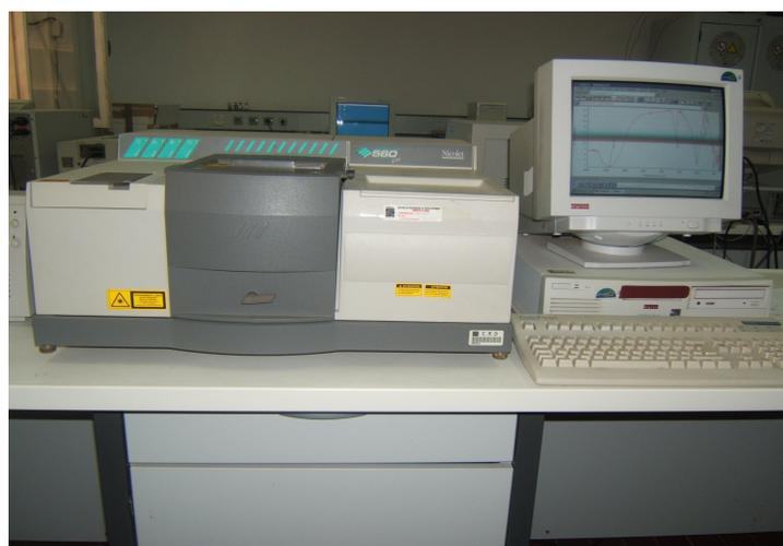
*Fig.II.3: spectrophotomètre infrarouge*
