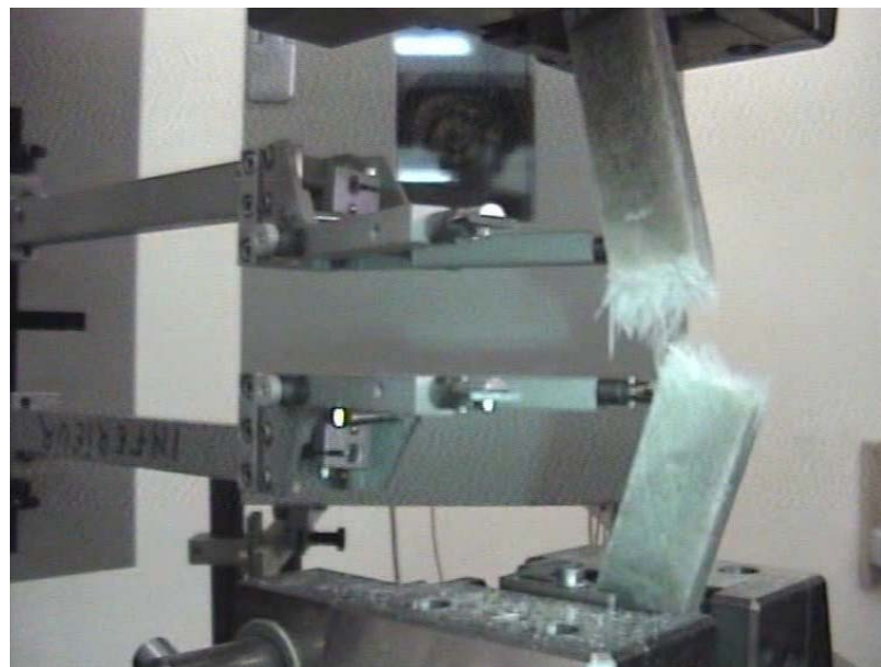
Figure C-2 : Rupture totale de l'éprouvette
