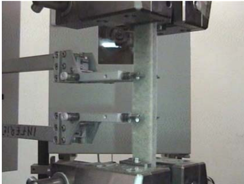
Figure C-1 : Début de blanchiment de la surface de l'éprouvette.
