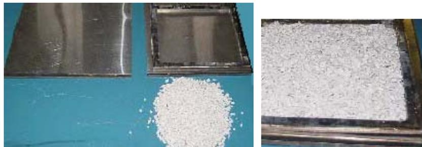
*Figure 17 : moule utilisé pour la préparation des plaques.*
