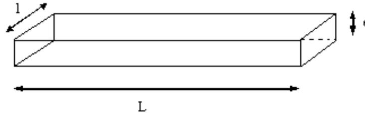
*Figure.24 : Schéma de l'échantillon pour l'essai de choc*
