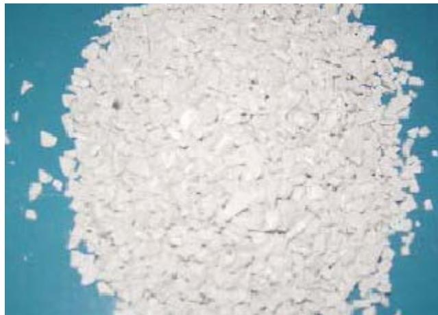
Fig. 58 : Image des grains obtenus après granulation des recyclats.
