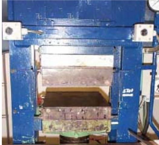
Figure 59 : La presse de moulage utilisée
