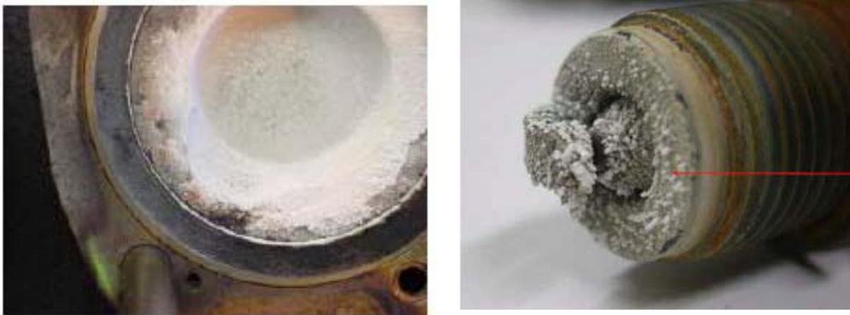
Fig. 4.1. Dépôts sur les éléments d'un moteur fonctionnant au biogaz (siloxanes) [147].
