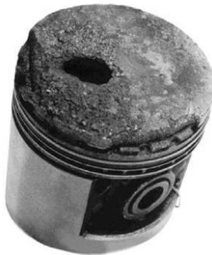
Fig. 2. Dommages provoqués par le cliquetis sur un piston [15].
