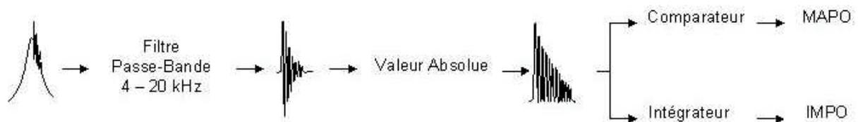
Fig. 3.4. Principe de mesure du MAPO et de l'IMPO
