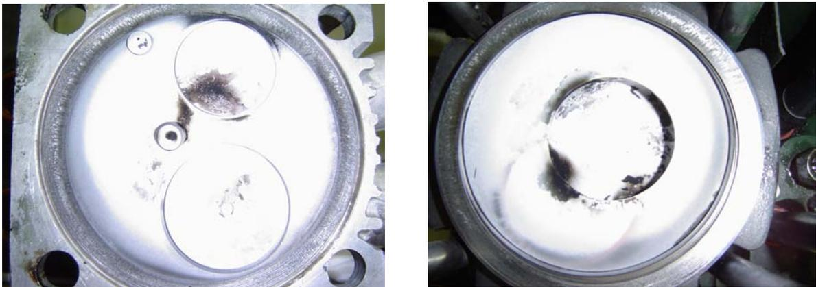
Fig. 4.5. Dépôts de siloxanes dans le moteur en mode dual-fuel.
