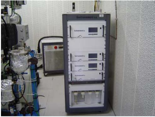
(a) Analyseur des gaz d'échappement
