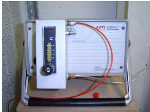
Fig. 2.6. Chromatographe en phase gazeuse.
