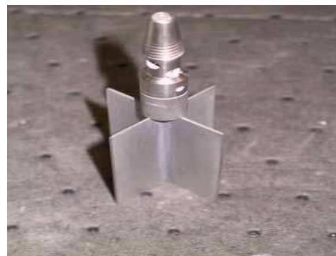
Fig. II.5 – Croisillon servant de cylindre intérieur dans la géométrie de Couette cylindrique. En tournant autour de son axe, le croisillon décrit un cylindre fictif dont la surface est de même rugosité que la pâte dans laquelle le croisillon est plongé.
