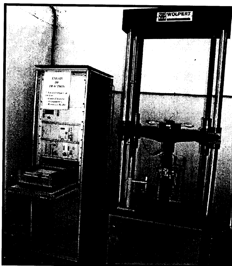
Machine de traction type Wolpert- Amsler équipée d'un four réglé (essai à 100°C)
