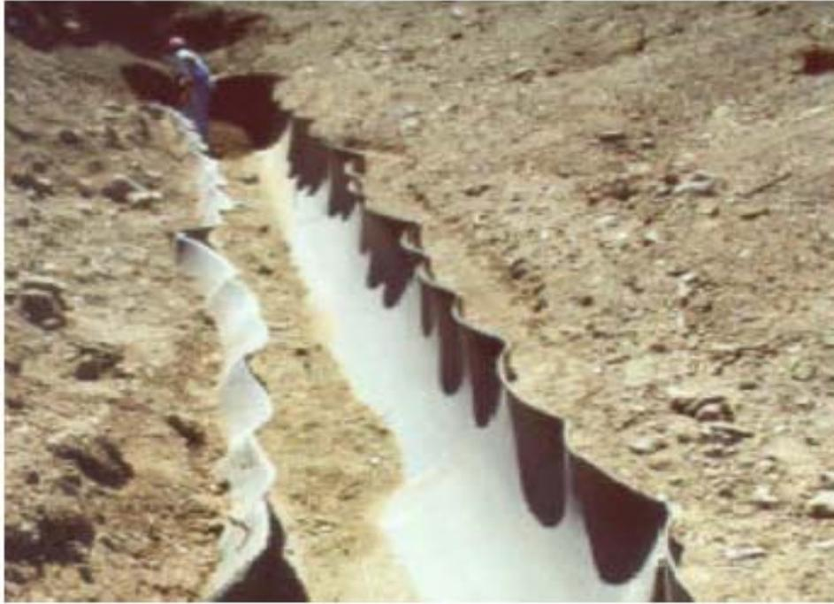
*Figure I.1 : Eclatement d'un pipeline [MAN. 01]*
