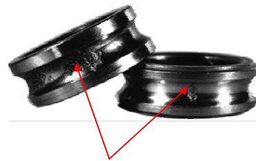
a) Défaut sur la bille "détérioration de la bille" b) Défaut de piste interne. [33] [22]
