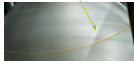
Figure III.2.14 : Effet de l'inclinaison sur le Spiral Wavy Mode à Ta=133
