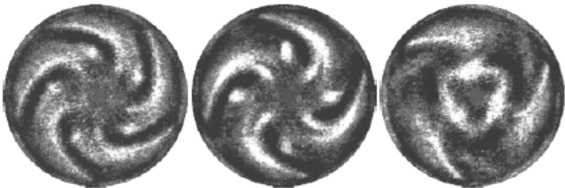
Figure 1.12: Visualisation d'écoulements dans la configuration d'espace annulaire large \delta=0.5 (vue région polaire): Ecoulement en spirale avec m=5 ( Re=1320 ), m=4 ( Re=1575 ) et m=3 ( Re=1680 ).
