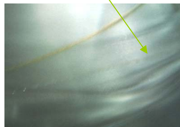
Figure III.2.14 : Effet de l'inclinaison sur le Spiral Wavy Mode à Ta=133
