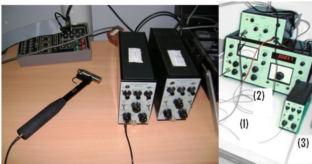
Figure III.12. Dispositif expérimental permettant l'application d'impact : (1) Structure rigide maintenant le montage expérimental, (2) Générateur (3) Amplificateur de charge du capteur de force.
