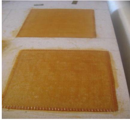
*Figure III.6. Plaque en composite de 4 plis élaborée par moulage au contact*
