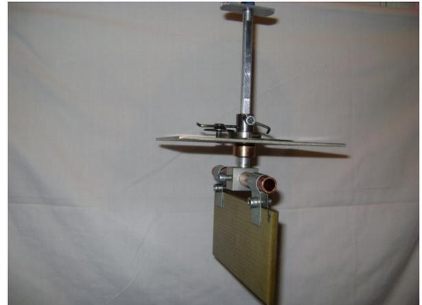
(a) Vue d'ensemble du montage expérimental (b) Dispositif de fixation de l'éprouvette utilisé pour les mesures ultrasonore
